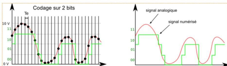
**Exemple :** Un signal quantifié à 3 bits sera représenté avec  $2^3 = 8$  valeurs possibles représentées par des combinaisons possibles d'écrire un nombre à trois chiffres avec des 0 et 1 : 000/001/010/100/101/110/111
