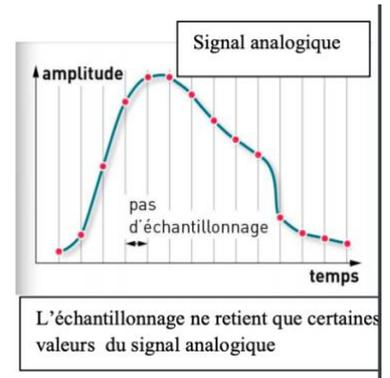
**Remarque :** La fréquence d'échantillonnage généralement retenue pour le son est de 44,1 kHz. Elle est adaptée car le domaine audible s'étend jusqu'à 20 kHz.
