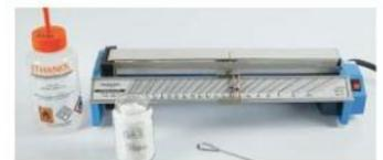
> Le banc Köfler permet de mesurer la température de fusion d'un solide.
